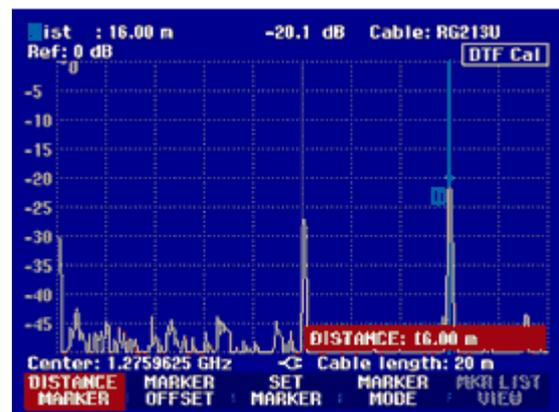
Para una mayor resolución, el R&S FSH ofrece una función de zoom en la posición del marcador. El eje x de la pantalla se puede acercar hasta un span de 3 m.
